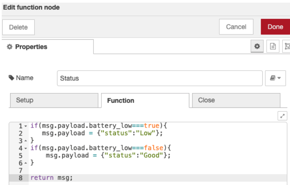
Figura 33. Nodo funtion del flujo del sensor de contacto. Estado de la batería.
